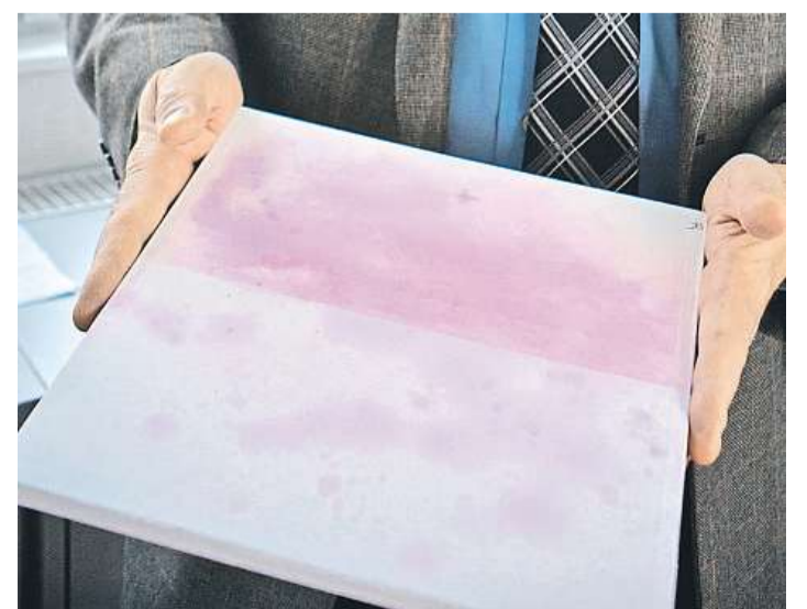
Samočistící efekt nátěrů je tak rychlý, kolik světla v prostředí je. Nahoře neupravená a dole upravená plocha pár minut po poprášení barvivem.
