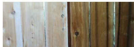
Kontrast FN® Wood ošetřené plochy (vlevo) a neošetřené plochy tmavé vlivem UV (vpravo)
