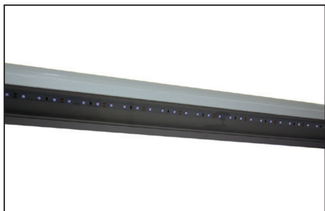
Detail aktivačního zdroje pod krycí a odrazovou deskou.
