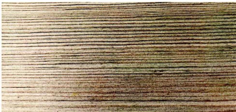
Foto 3 – Vzorek A 2 po vystavení po dobu 365 dní ve venkovní expozici
