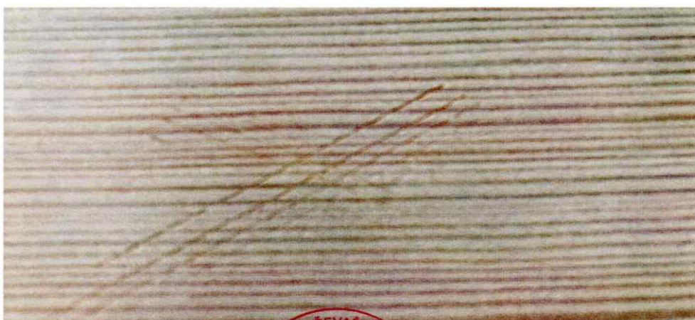
Foto 4 – Vzorek B2 po vystavení po dobu 365 dní ve venkovní expozici.
